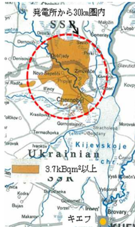
(d) チェルノブリ原発周辺の プルトニウム 239+240 の沈着状況
