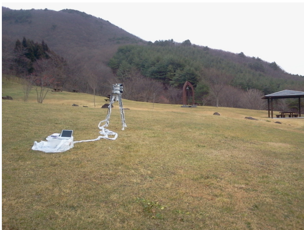
図 3.2.1-1 ゲルマニウム半導体検出器を用いた in-situ 測定の様子
