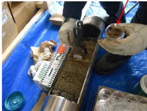
(c)ロッドからの土壌試料の採取（スクレーパーにより採取区間を仕切り、中心部分のみから採取）
