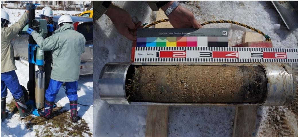
(a)ポータブルドリルと大口径サンプラー（内径 150mm）による掘削作業（左写真：地中への押し込み状況）と(b)採取された土壌コアの例（右写真：開口した状態のロッド）
