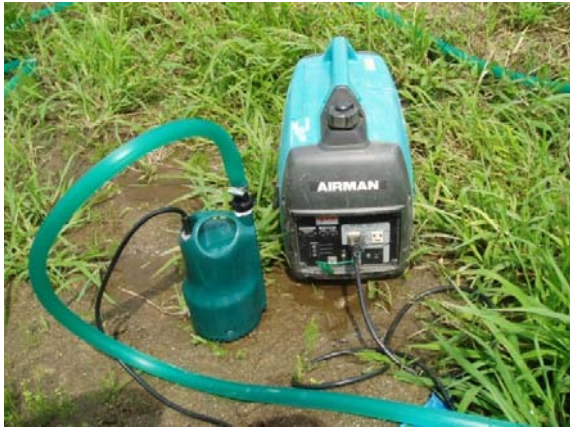
写真 5.3.2.1-17 ウォーターポンプ
