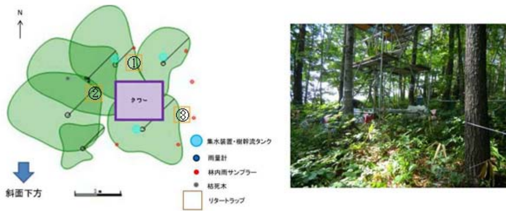
図 5.3.1.2-2(b) 広葉樹混合林サイトの林内雨サンプラー設置状況
