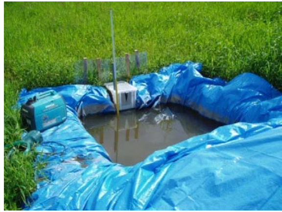
写真 5.3.2.1-16 濁水で満たされた 土砂トラップ
