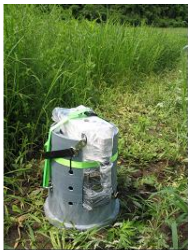
写真 5.3.2.1-25 環境中での測定 (in-situ 測定) に用いた可搬型ゲルマニウム半導体検出器
