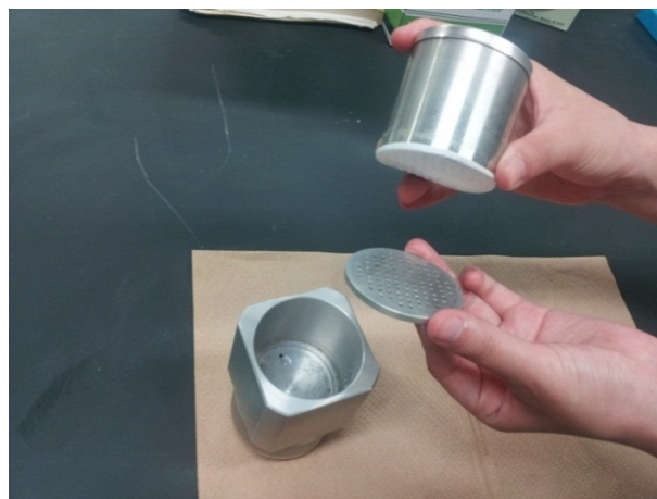
(2) 土壌サンプル底部に濾紙とステンレス網を装着する様子
