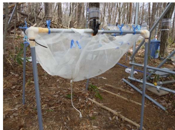
写真 5.3.1.2-4 広葉樹混合林に設置されたリタートラップ
