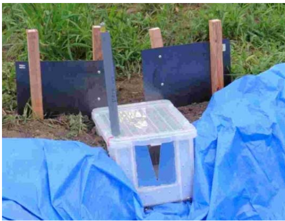
写真 5.3.2.1-12 土砂トラップに設置 した三角堰と水位計
