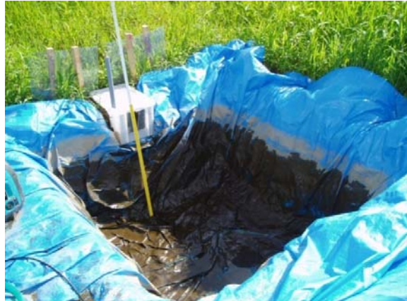
写真 5.3.2.1-18 流出水を排水したトラップ
