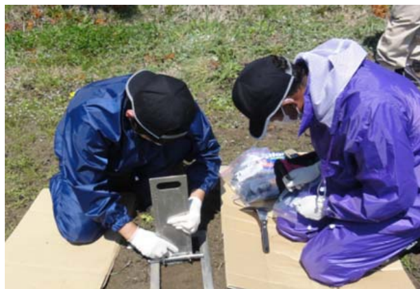
図 5.3.1.1-2 土壌を層別に採取する装置（スクレーパープレート）による土壌採取風景
