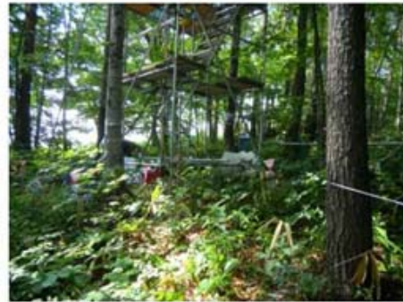
図 5.3.1.2-2(b) 広葉樹混合林サイトの林内雨サンプラー設置状況
