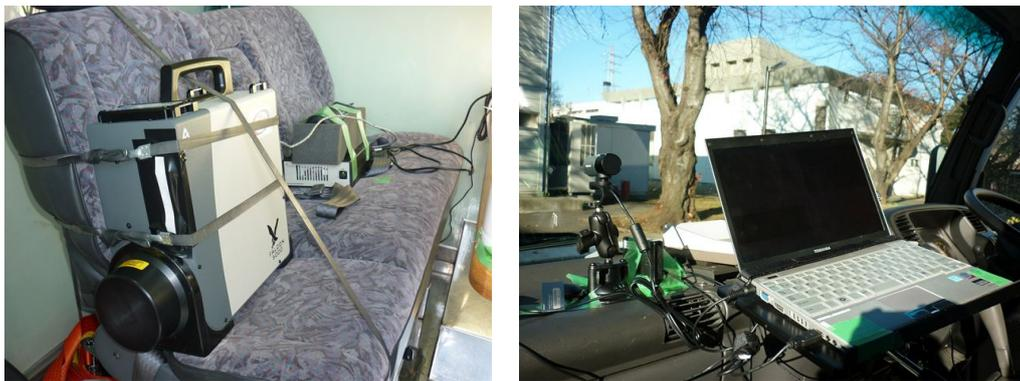
図 3. 4. 2-2 ラジプロープの可搬型 Ge 検出器 Falcon5000 (左図) および助手席に設置されたノート PC、USB カメラ、GPS、モバイル通信機 (右図)。検出器から無線ネットワークでノート PC がデータを受け取っている。
