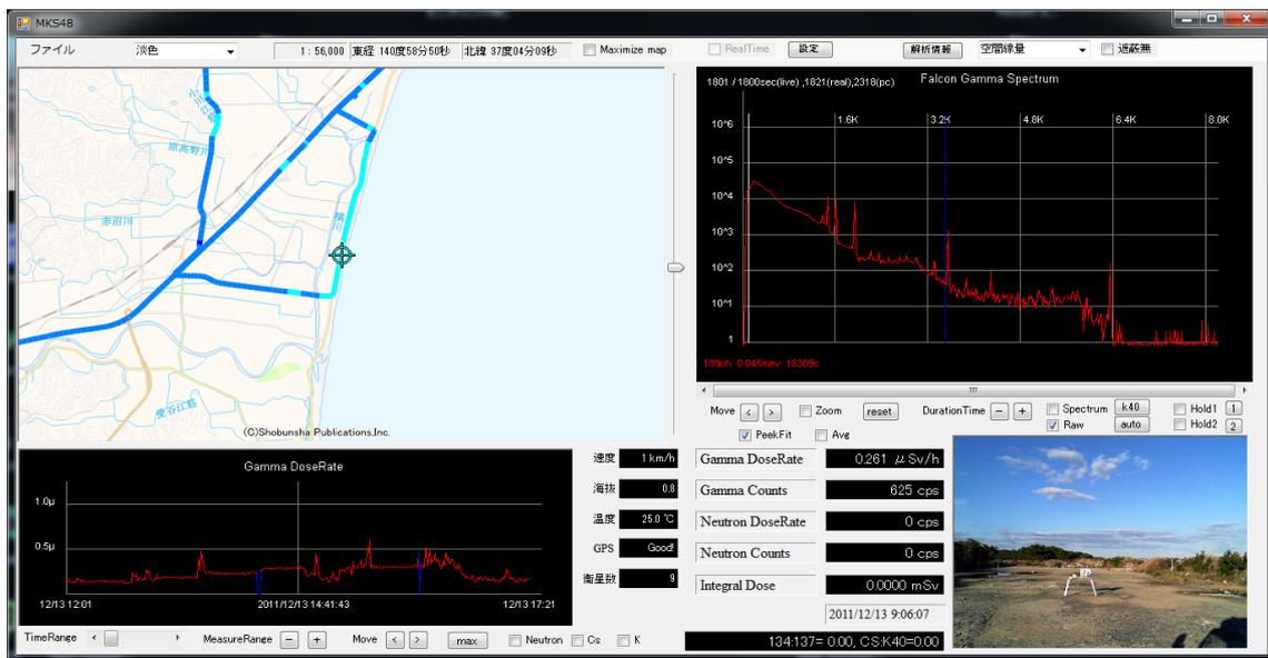
図 3. 4. 2-3 ラジプロブの画面表示。左上のパネルで地図上での位置、および、各地点の空間線量率をカラー表示し、また、右上のパネルで Falcon5000 もしくは HDS-100GN で計測された  $\gamma$  線スペクトラムを前後 15 分間積分して表示、左下のパネルには HDS-100GN による空間線量率、右下のパネルにはその地点での車両前方の静止面を表示している。静止面には定点計測の様子が写っている。可搬型 Ge 検出器は車外でアルミ製の作業台の上に設置されている。
